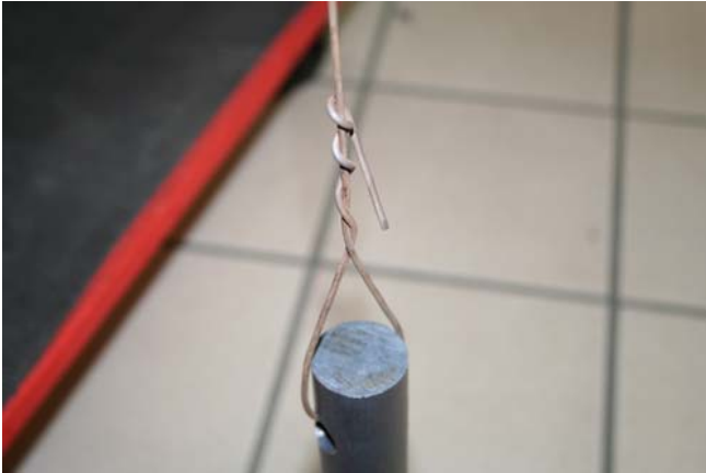
Esempio della tecnica di legatura adottata.
