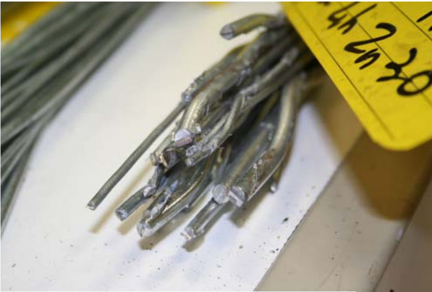
Un gruppo di campioni di filo sottoposto a zincatura aspetta l'inizio dei test..
