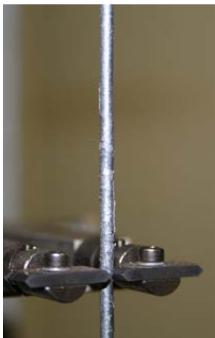
I test su campioni zincati risultano spesso nel distacco della parte esterna del rivestimento.
