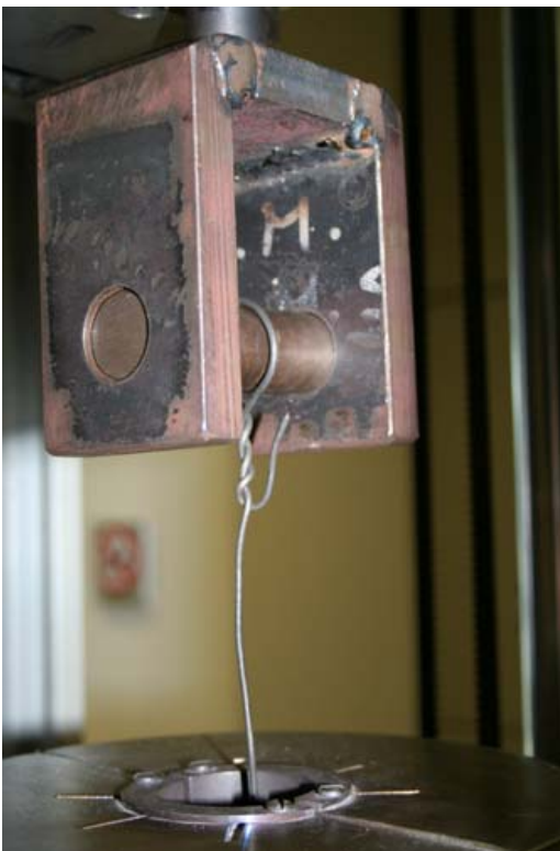
Dettaglio della legatura superiore, con il punto di aggancio tondo e l'ingresso nella parte superiore del forno elettrico.
