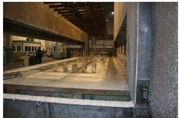
L'estrazione dal bagno di zinco è quasi completa.
