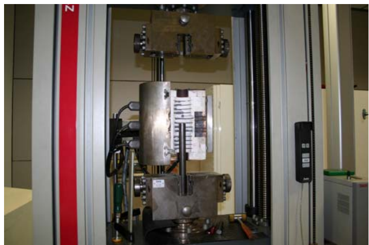
Set up della Zwick Z150 per i test sul filo legato ad alta temperatura. Sono visibili un forno elettrico cilindrico e la barra di tondo forata con spigolo vivo per la simulazione del pezzo legato.
