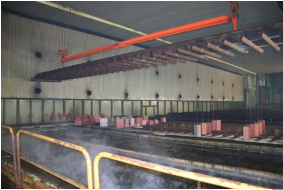
I fili opportunamente caricati entrano nel decapaggio.
