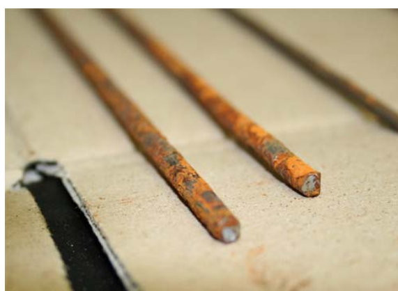
Particolare dello stato corrosivo prima della spazzolatura.
