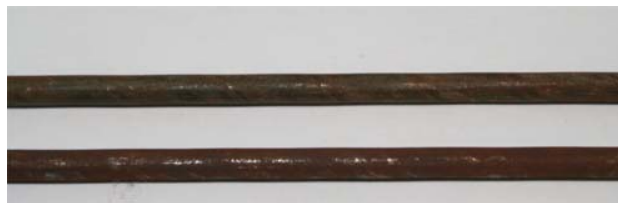
Ossidazione risultante dai test in camera umidostatica.
