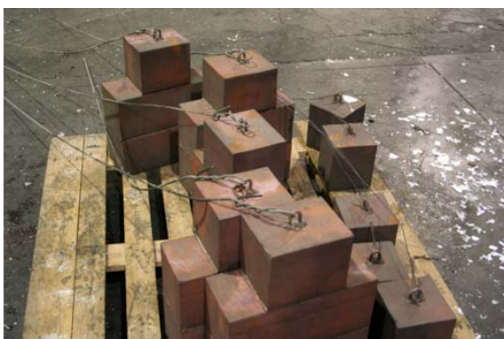
Pesi ricavati da profili in acciaio per i test industriali. Sono qui visibili due misure già pronte per la preparazione della traversa.
